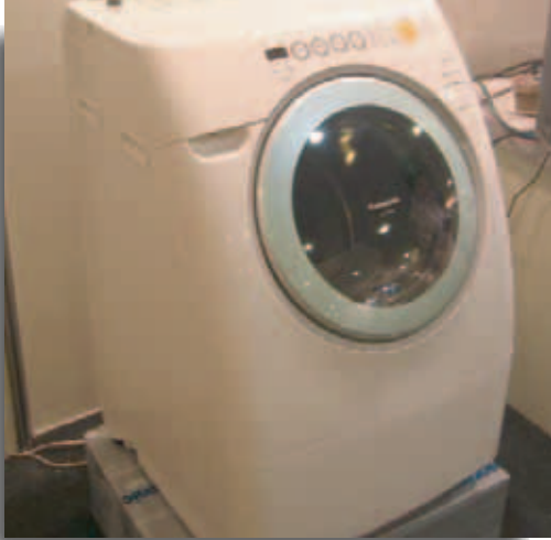
Fig. 31 y 32. Esta lavadora dispone de una boca de acceso inclinada para evitar agacharse, botones y letras grandes para facilitar la comprensión de las instrucciones e indicaciones en “braille”.
