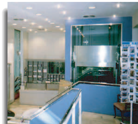
Fig. 11 y 12. Una correcta utilización del ascensor permite resolver situaciones complejas. Este local con escasa superficie a nivel de calle se convierte en accesible mediante un ascensor de doble puerta que permite acceder al semisótano y al attillo.
