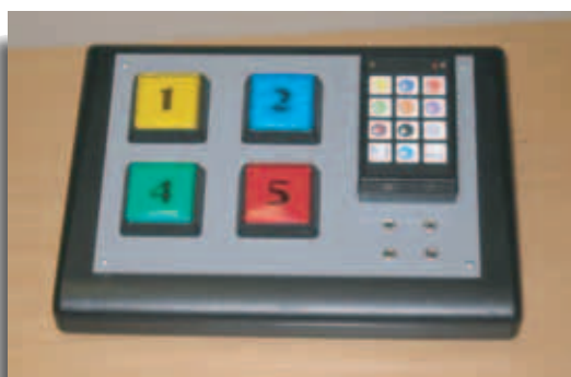
Fig. 35 y 36. Mandos a distancia con pulsadores grandes, de colores vivos, sin aristas, etc. y teclados con las letras contrastadas, con línea Braille, etc. pueden facilitar la interacción a multitud de usuarios con dificultades.
