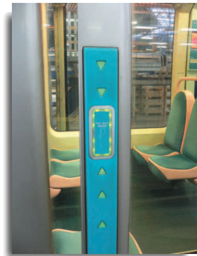
Tranvía de Estrasburgo. Señal visual de cierre de puertas.
