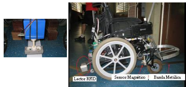
Figura 16: Detalle del sensor magnético (izquierda) y localización del sensor, del lector RFID y banda metálica.
