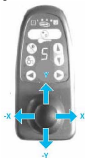
Imagen 2. Ejes x e y del joystick de la silla de ruedas.
