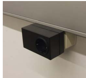
Figura 4. Encapsulado final de un nodo interruptor
