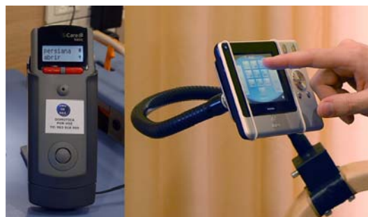
Imagen 4. Mandos de voz y táctil que permiten controlar elementos del centro de forma centralizada
