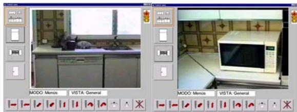
Fig. 5 Ejemplo de interfaz visual que combina imágenes reales de las cámaras e iconos de módulos seleccionables y órdenes al robot
