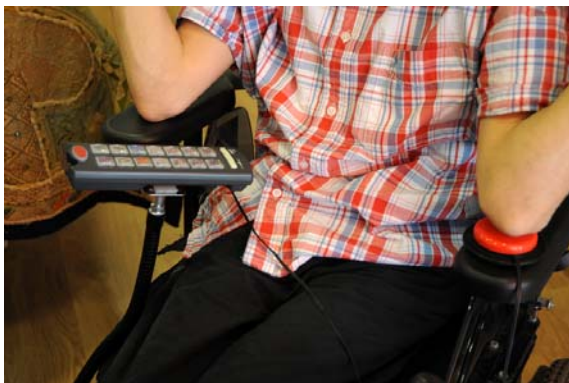
Imagen 7. Valoración del acceso al control de entorno con un mando de barrido
