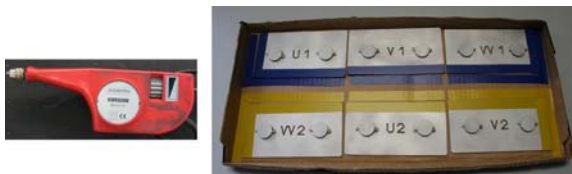
Ilustración 6: plantillas para marcado de aisladores y marcador eléctrico
