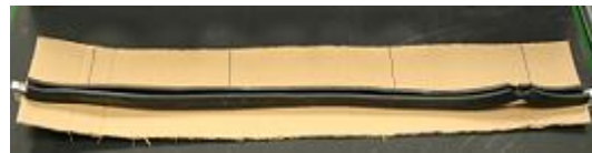
Ilustración 7: Economía de medios; prototipo de útil para facilitar la aplicación de pegamento en el interior de la cantonera de goma
