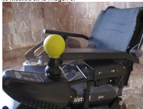
Imagen 6. Ubicación del dispositivo en la silla de ruedas.
