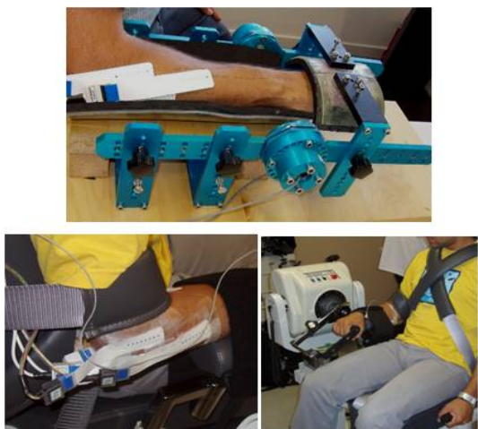
Figura 8. Mecanismos para registrar señales sEMG multicanal en condiciones controladas. Brazo isométrico (arriba). Máquina Isocinética (abajo)
