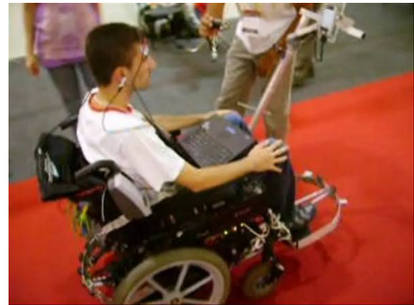
Figura 3: Silla de ruedas comandada por parpadeos.
