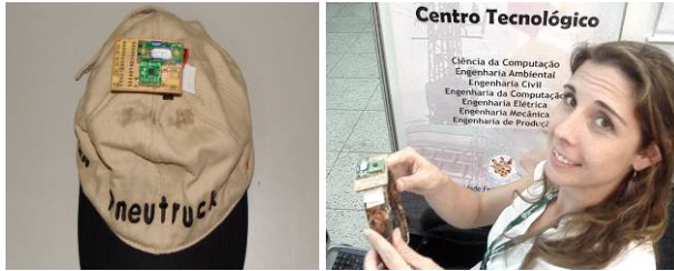
Figura 4: Sensor de inclinación basado en acelerómetro adaptado a un gorro y a un arco de pelo.
