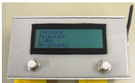
Figura 5. Detalle del controlador integrado. Se ha detectado un televisor, una lámpara y un interfaz gestual
