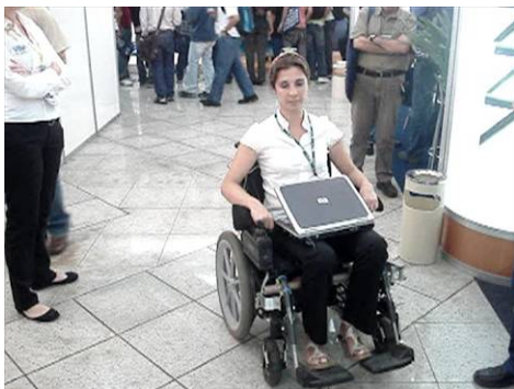
Figura 6: Silla de ruedas comandada por movimientos de cabeza (capturados por acelerómetro).
