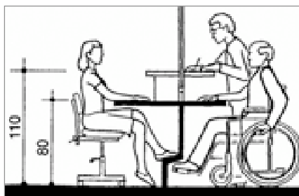
Mostrador a doble altura y con espacio para la aproximación de una persona en silla de ruedas
