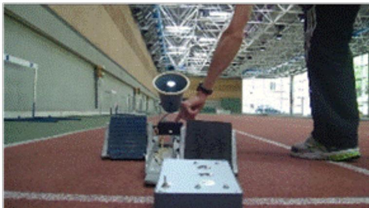
Figura 160 Dispositivo para marcar la salida a atletas con discapacidad auditiva
