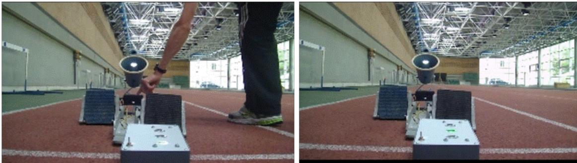
Figura 134 Dispositivo para señalar la salida en pruebas de alta competición para atletas con discapacidad auditiva
