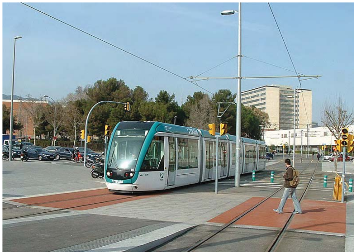
Paso de peatones a nivel
