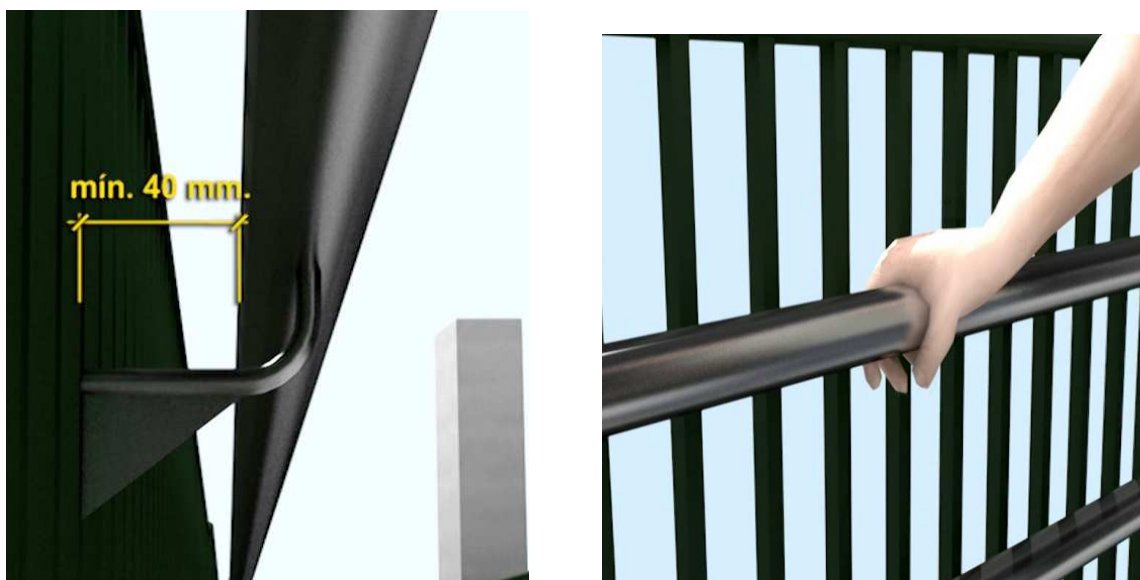
Sistema de agarre deslizante y no interfiere el paso de la mano. Fuente: Junta de Andalucía 5
