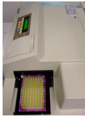
**Figura 15.** En los eluatos<sup>181</sup> de los 10 primeros pocillos de la primera fila están los patrones de galactosa de la figura 13, por duplicado, de 50, 100, 200, 300 y 400 mg/dL, el trasvase de los 20  $\mu$ L de eluato a la placa de plástico de fondo plano, incluye estos 10 pocillos; se añaden 150  $\mu$ L del
