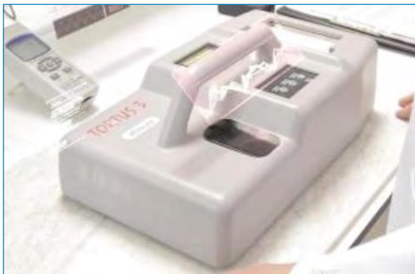
Figura 9. Método de ensayo TORTUS./ www.laboratorioderesbaladicidad.com .
