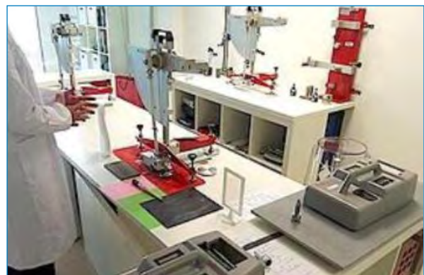
Figura 8. Método de ensayo TORTUS./ www.laboratorioderesbaladidad.com .
