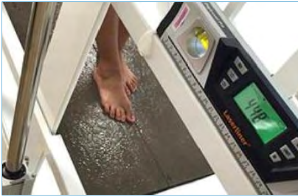
Figura 6. Ensayo de rampa pies mojados./ www.laboratorioderesbaladidad.com .
