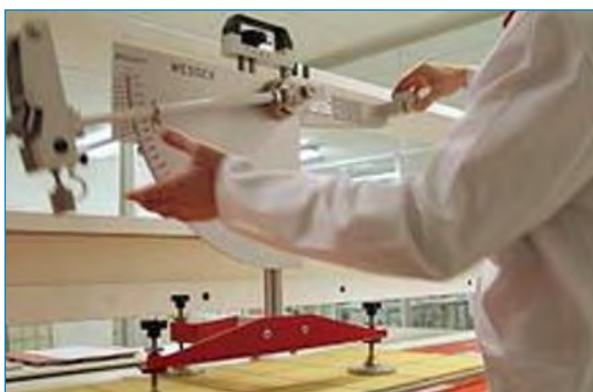
Figura 3. Método de ensayo del péndulo./ www.laboratorioderesbaladidad.com .
