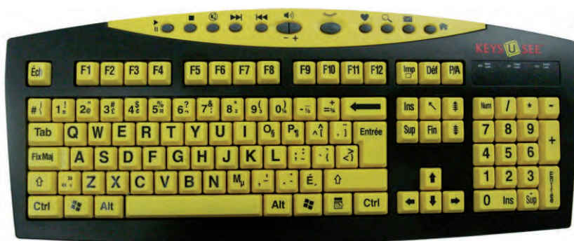
Figura 32. Teclado con letras magnificadas./ CIDAT
