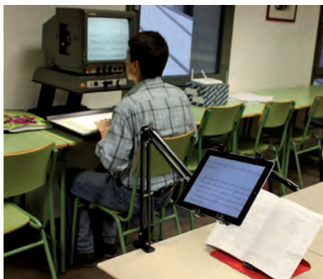
Figura 42. Imagen de uso de lupa televisión y tableta usada como lupa televisión./ Elaboración propia.
