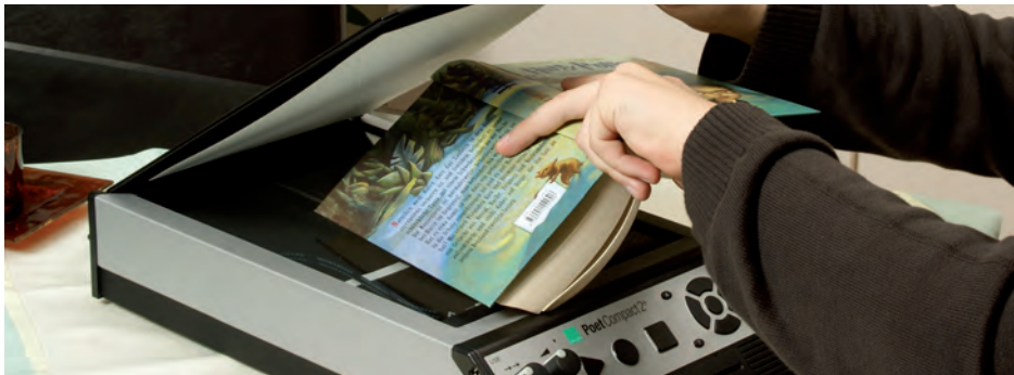
Figura 63. Modelo de lector óptico de caracteres – BAUM Poet Compact 2+/ CIDAT 6 .
