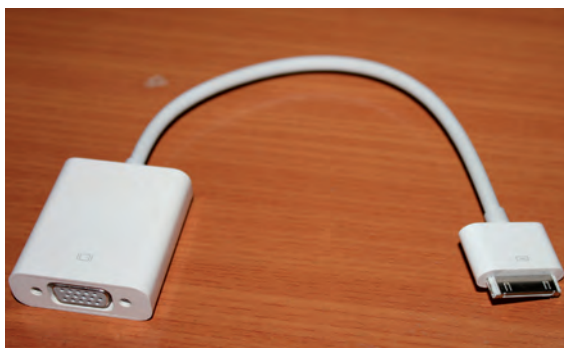
Figura 50. Adaptador de conectores de la tableta a la pantalla./ Elaboración propia.
