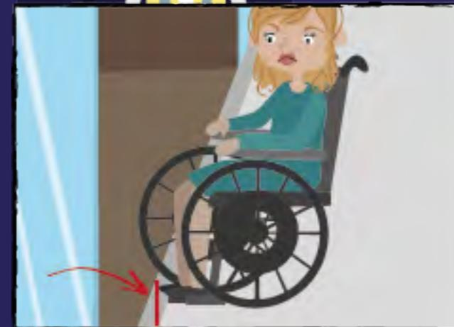
Si existe desnivel entre la acera y el interior del edificio, la silla de ruedas de LIS no puede superarlo y no puede acceder al interior.
