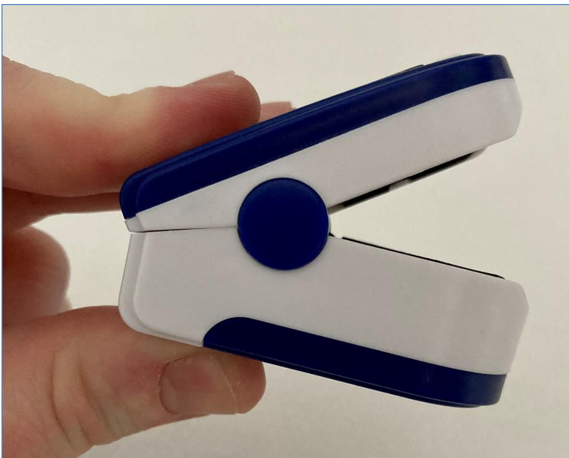
Figura 26: ejemplo de acción que requiere fuerza para abrir la abertura de introducción del dedo.
