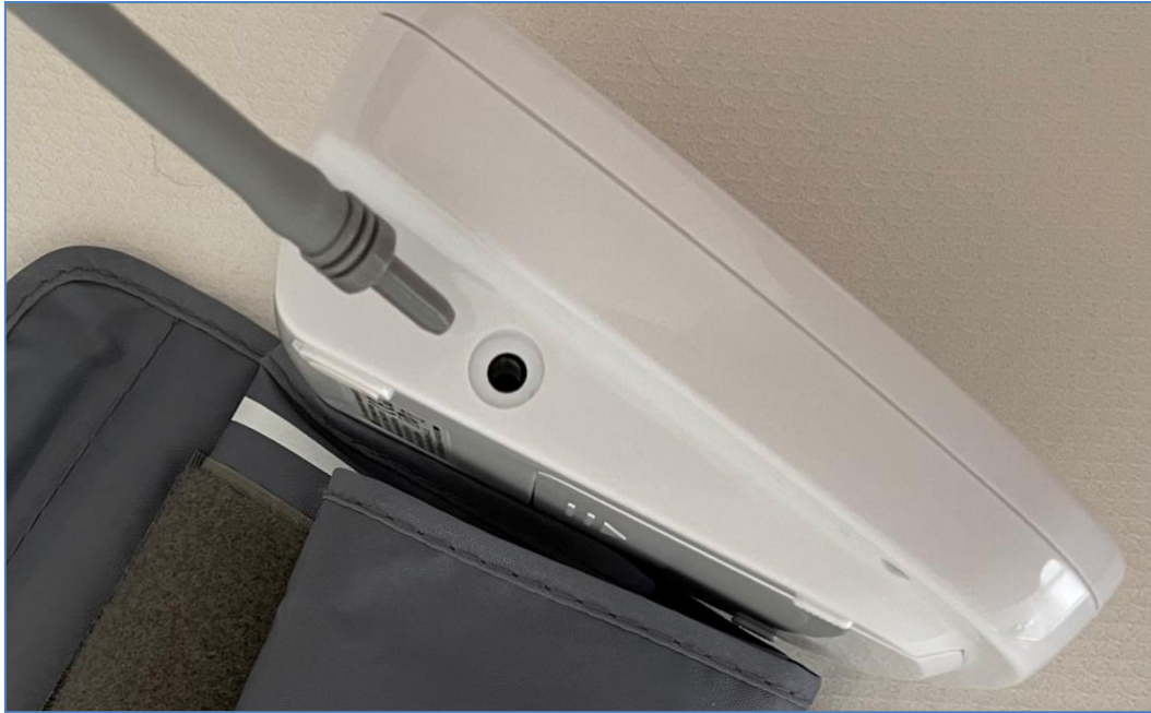
Figura 20: conexión del brazalete con el dispositivo.
