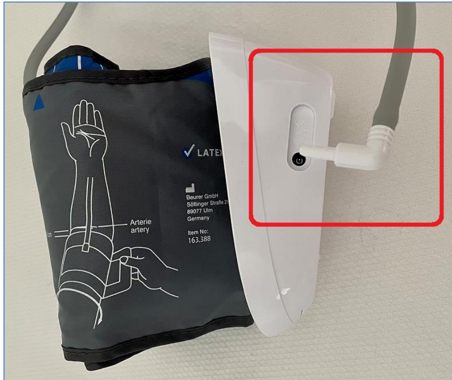
Figura 6: conexión del brazalete con el dispositivo.
