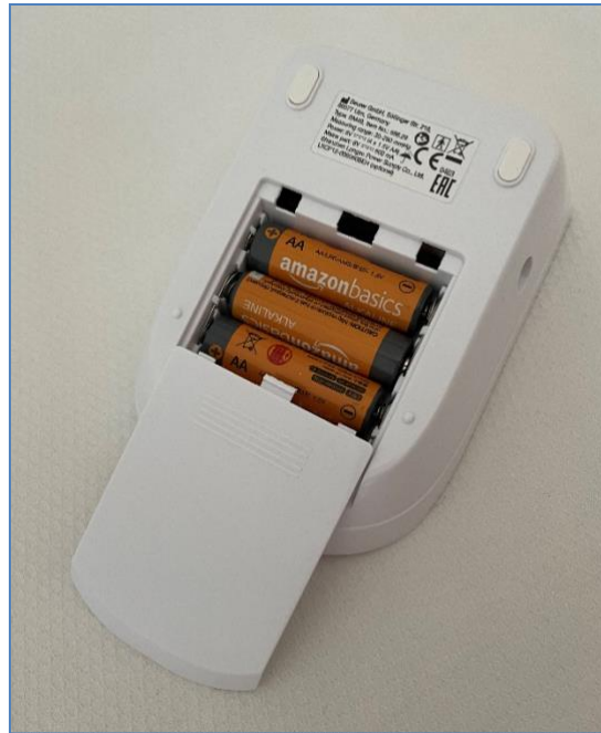
Figura 5: tapa del compartimento de las pilas.
