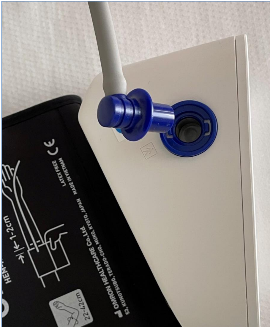
Figura 13: conexión del brazalete con el dispositivo.
