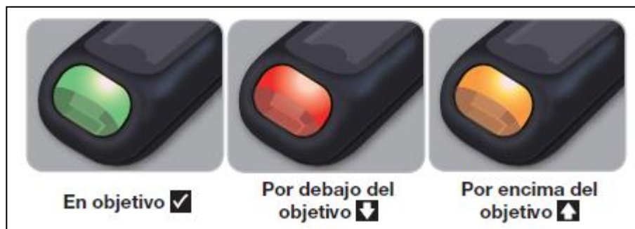
Figura 39: ejemplo de uso del color en el puerto de análisis de la tira reactiva del dispositivo.
