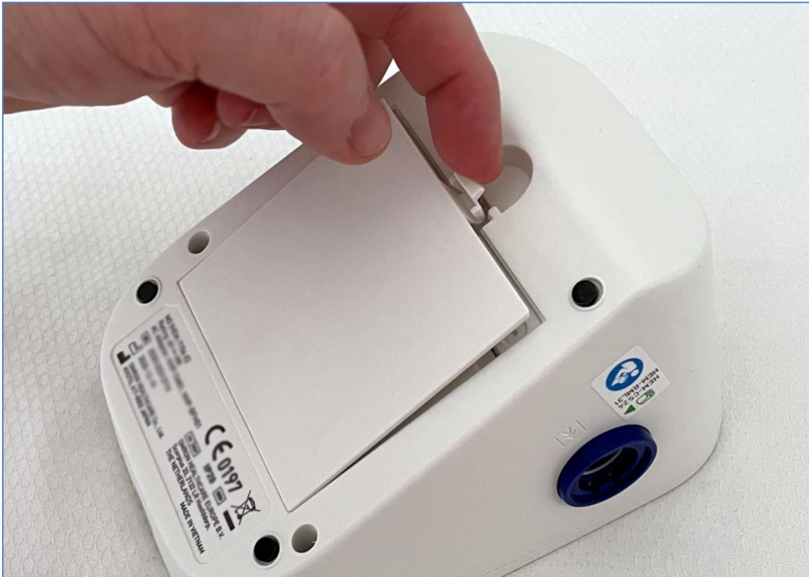
Figura 12: tapa del compartimento de las pilas.
