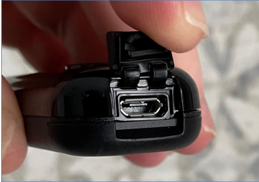
Figura 43: puerto de datos del dispositivo.
