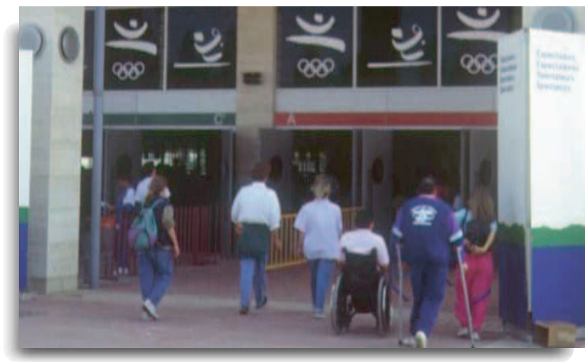
Fig. 3. Palau Sant Jordi. Barcelona. Proyecto de Arata Isozaki (1988-1991). Los accesos del público desde la plaza central del Anillo Olímpico se producen en horizontal al nivel intermedio de las gradas, lo que acorta los itinerarios de evacuación y permite disponer de asientos para personas con discapacidad sin tener que salvar desniveles.
