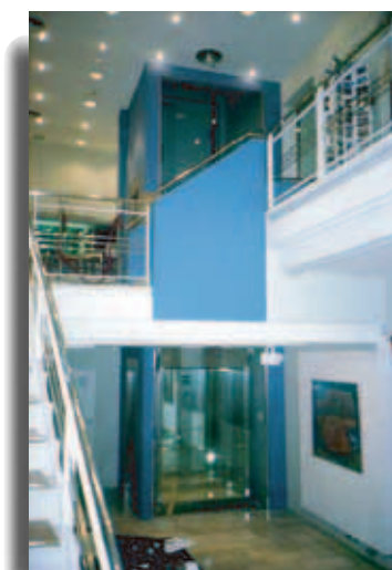
Fig. 11 y 12. Una correcta utilización del ascensor permite resolver situaciones complejas. Este local con escasa superficie a nivel de calle se convierte en accesible mediante un ascensor de doble puerta que permite acceder al semisótano y al attillo.
