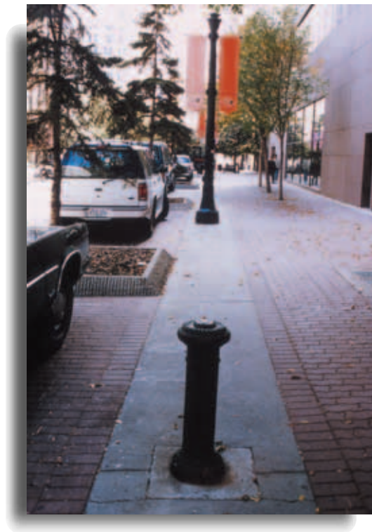
Adecuada alineación de bolardos y báculos de iluminación.
