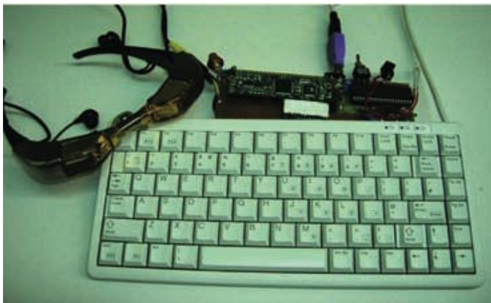
Figura 4: Circuito electrónico microcontrolador junto con gafas de visionado y teclado
