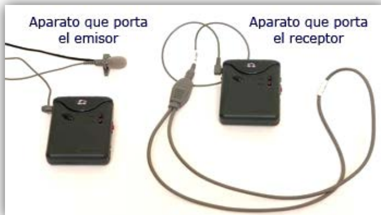
Figura 26. Aparatos que conforman el sistema FM. Fuente: Asociación EUNATE elkarte
