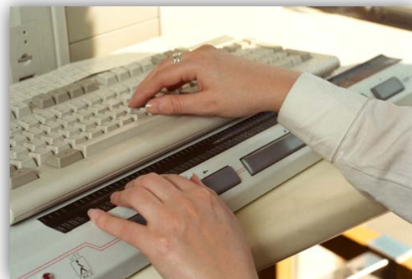
Imagen 3. Línea Braille. Fuente Banco de imágenes de la ONCE.
