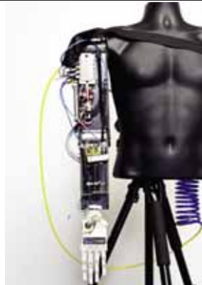
AMO está diseñado a base de bombas, válvulas neumáticas y un tanque de aire comprimido.
