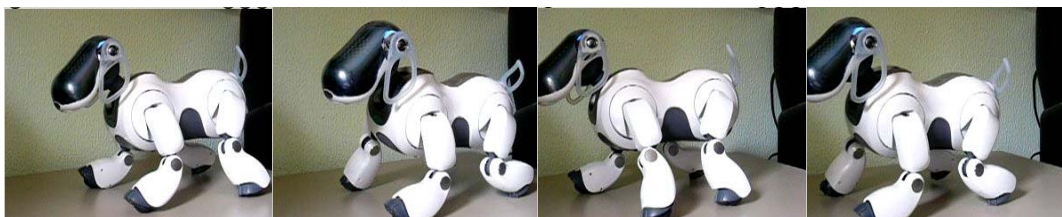
Figura 11. Resultado del entrenamiento de los CPG's interconectados : Locomoción del Aibo
