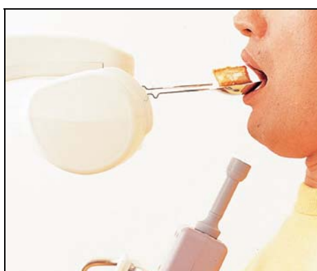
Figura 5.- El tenedor se retrae cuando contacta con la boca.
