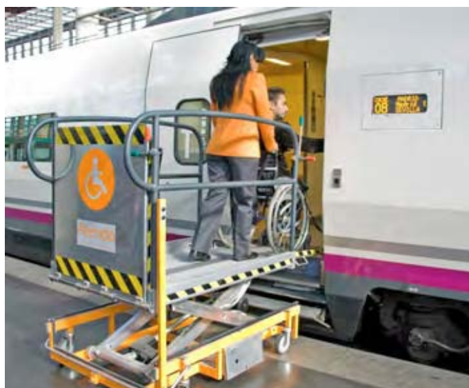
Tren AVE serie 100. Acceso de una persona usuaria de silla de ruedas desde un andén bajo mediante un elevador móvil de andén
