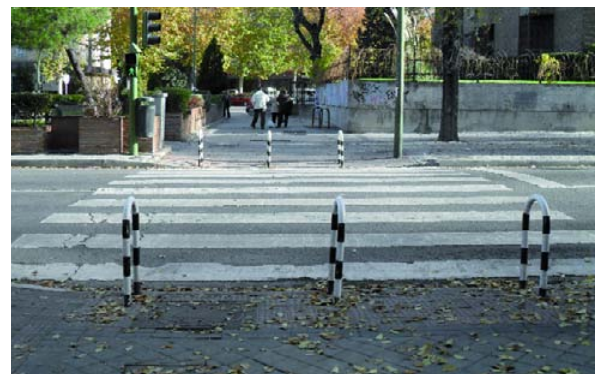
Figura 20 y 21 : Bolardos colocados en bordillo rebajado y acera para evitar el estacionamiento de vehículos.
