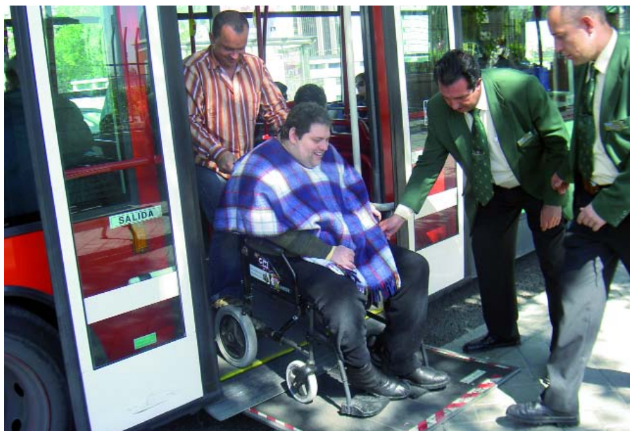
Figura 60: Persona en silla de rueda utilizando la rampa motorizada.
