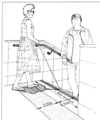
Figura 8: Pasamanos prolongados al inicio y al final de la escalera.
