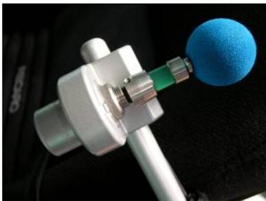
Es apropiado para personas con un movimiento muy preciso, pero con poca fuerza para desplazar la palanca. Puede ser colocado para manejarlo por diferentes partes del cuerpo.
