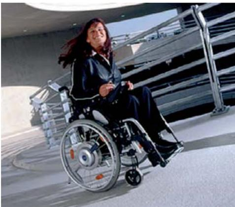
Está formado por dos motores que están embutidos en las ruedas motrices, un *joystick* para conducir y dos baterías con su correspondiente cargador. La ventaja es su reducido peso y la facilidad de plegado y transporte. Su potencia y su autonomía son menores que las de una silla de ruedas eléctrica convencional y no dispone de mandos especiales, aunque alguno de los
