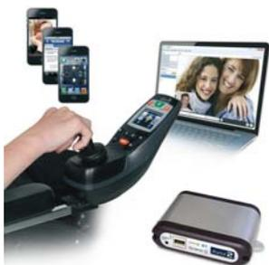
Existe un sistema que permite controlar los dispositivos Apple (Iphone, Ipad...) con el mando de conducción de la silla de ruedas. Se conecta por bluetooth.
