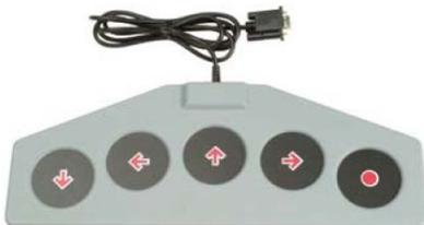
Son cinco botones, cuatro para las direcciones y otro para encendido/apagado que funcionan por contacto y están incrustados en una bandeja plana. Su uso más común es colocándola sobre una mesa o
