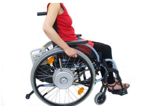
Es un dispositivo de propulsión eléctrica para sillas de ruedas bimanuales. Consta de dos motores eléctricos acoplados o incorporados a las ruedas motrices de una silla
