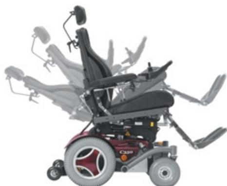
La basculación es la inclinación manteniendo fijo el ángulo entre el asiento y el respaldo. Facilita el control postural, el descanso y una variación significativa de las zonas de presión sin cambiar el ángulo de la articulación de la cadera. Esta variación será más o menos significativa dependiendo del ángulo de esta basculación. También puede ser útil una
