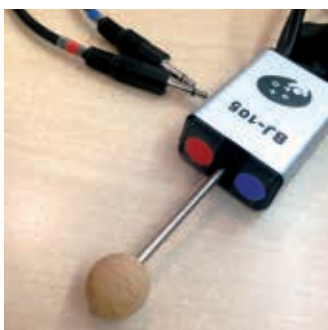
Pulsador doble de varilla, en realidad son dos pulsadores ultrasensibles en una sola palanca.
