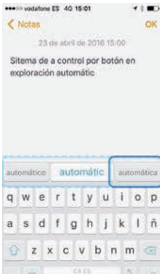
Control por botón en modo exploración por ítems, que es el modo por defecto. En este caso, usando un barrido automático.
