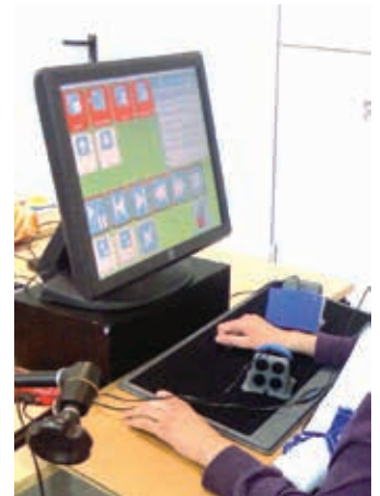
Usando The Grid 2 para controlar la música, a través de dos pulsadores colocados sobre cuñas.
