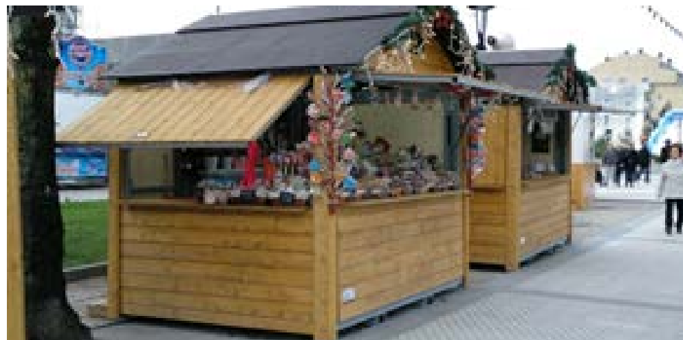
Ejemplo de quioscos con altura de mostrador no accesible y elementos tipo toldo a baja altura
