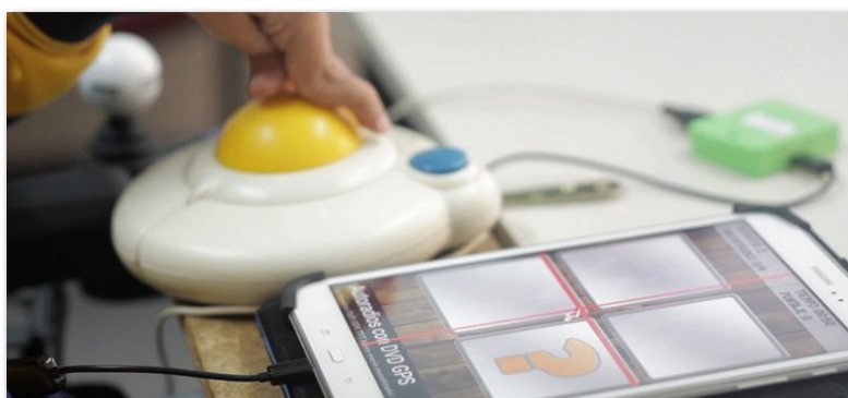
Ilustración 5. Una persona con discapacidad motriz accede al dispositivo móvil mediante un trackball . Fuente de la imagen: “ MOUSE4ALL - Accesibilidad para smartphone y tablet ”
